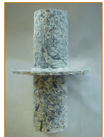
Figura 4: Muestra galvanizada después de la prueba
